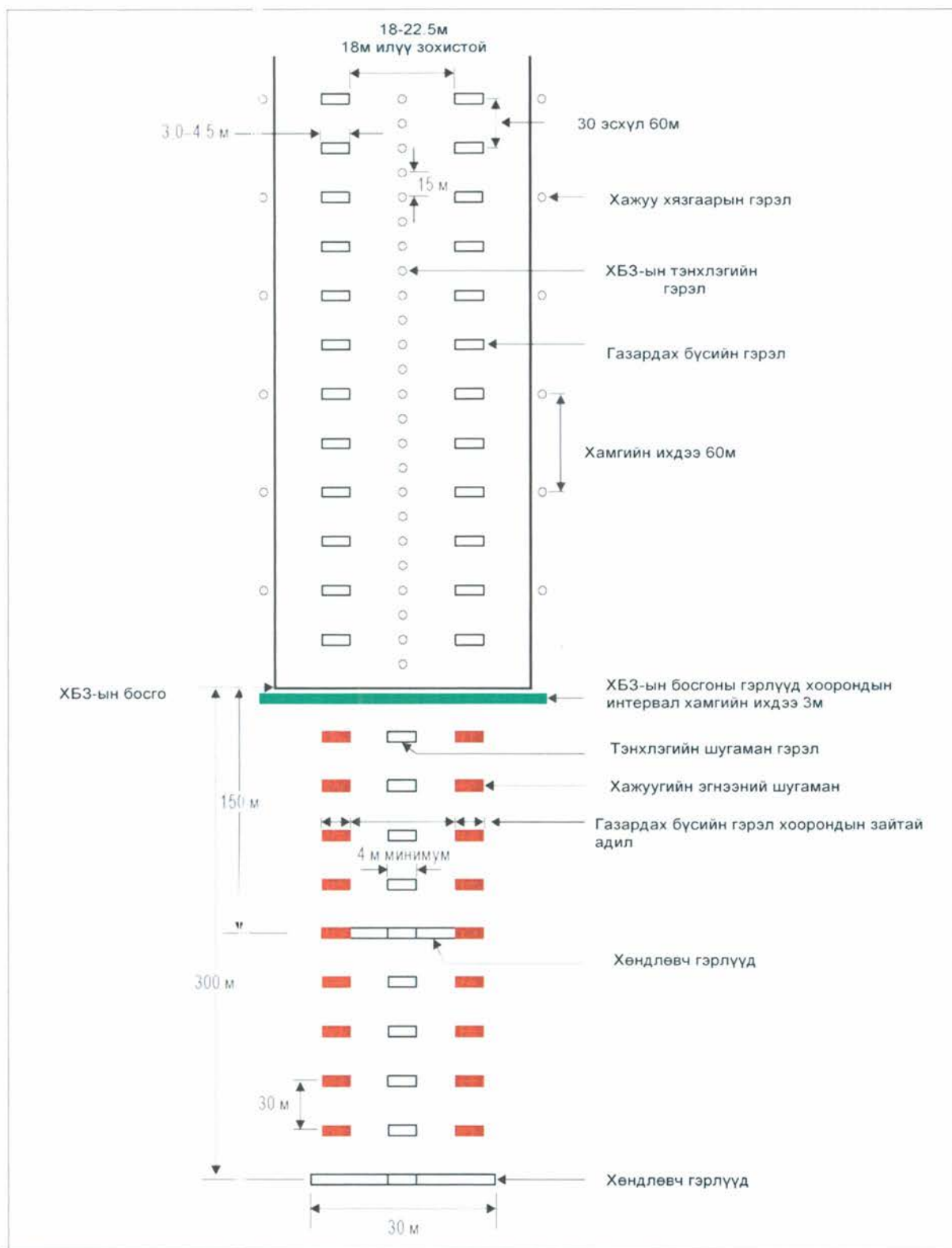
Зураг 5-14. Нарийвчлалтай ойртолтын II ба III зэрэглэлийн тоноглолтой ХБЗ-ын босгоноос 300 м зайд байрлалтай ойртолтын болон ХБЗ-ын гэрлүүд в) ХБЗ-ын босго 300 м эсвэл түүнээс дээш зайд шилжсэн үед нэг гэрлийн үүсвэр хэлбэртэй байх бөгөөд тэдгээр нь бүгд хувьсах цагаан гэрэл цацруулна.
